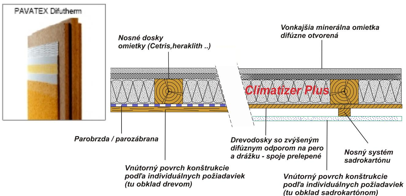
Drevené stojky sa z vonkajšej strany opláštia len difúznym nosičom omietky (napr. cementom spájané dosky z drevitej vlny (HWL)). Debnenie konštrukcie upevnené z vnútornej strany potom musí slúžiť ako výstuž. Ak sa tu použijú dosky z lepeného dreva s lepenými spojmi, dá sa spravidla upustiť od parobrzdy (previesť výpočte difúzie pára podľa ČSN EN ISO 13788). Na vonkajšiu omietku sú vhodné minerálne výrobky s malým difúznym odporom.
