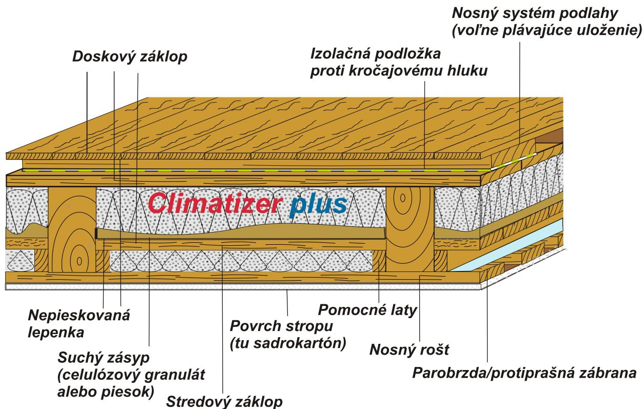
Odborné spracovanie protiprachovej izolácie pod sypaným materiálom umožňuje väčšiu toleranciu pri príreze spodných dosiek (dosky sú uložené na pridržovacích lištách) Tepelnú izolačnú účinnosť konštrukcie možno zvýšiť, keď sa CLIMATIZERom PLUS vyplnia aj d utiny vzniknuté medzi hranolmi (hore) a pridržovacími lištami (dole).
